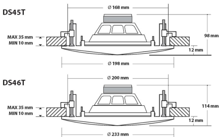
Корпус выполнен из огнеупорного пластика, имеет очень компактный профиль. Съемная защитная решетка легко перекрашивается синтетическими эмалями необходимого цвета.
