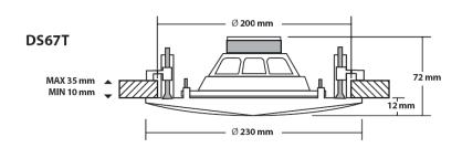
Корпус выполнен из огнеупорного пластика, имеет очень компактный профиль. Съемная защитная решетка легко перекрашивается синтетическими эмалями необходимого цвета.
